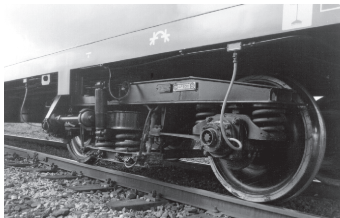
Podvozek GP 200 osobního vozu Btme pro rychlost do 200 km/hod.
