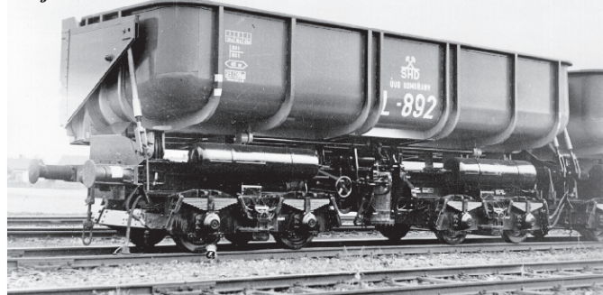
Čtyřnápravový výklopník řady LH, Linke-Hofman s ložným objemem 40m 3
