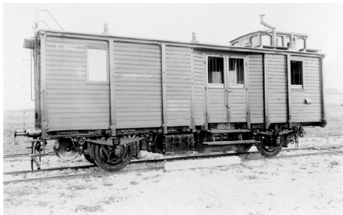
Dvounápravový poštovní vůz Fk pro Severní dráhu Ferdinandovu, rok výroby 1902
