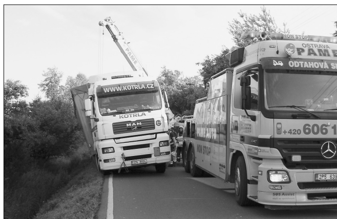
▲ Zúžený úsek silnice si vybírá svou daň – s kamionem se utrhla krajnice a musel být vyzvedáván těžkou technikou. Foto: A.P.H.
