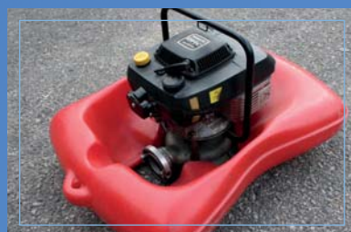
Nově pořízeno motorové plovoucí čerpadlo o výkonu 1100 l/min.
