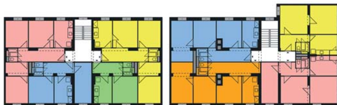
Typické podlaží sekce T16 a upravená sekce T16 pro kolmé napojení dalších sekcí
