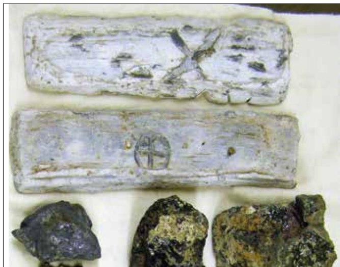
Železná brána - olověné ingoty, galenit a struska.
