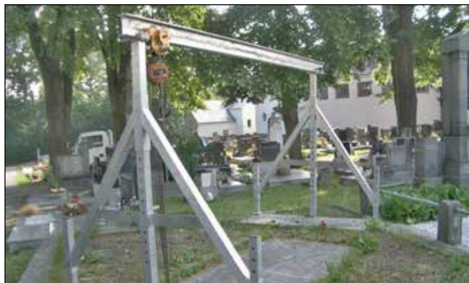
Konstrukce montážní rampy s kladkou firmy Kamenictví Jakubík Odry pro instalaci trojdílného náhrobku, věnovaného rodině Vanzin na jejich vyprázdněném hrobovém místě. Foto: Pavel Kašpar st. – 2022
