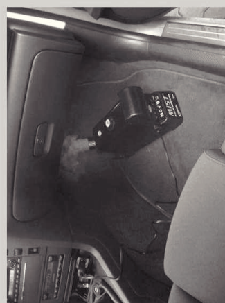
Čištění ventilace ultrazvukovým přístrojem
