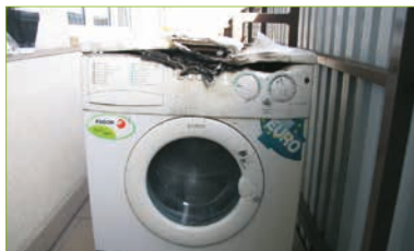
Věnujte pozornost technickému stavu elektrických spotřebičů – pračka poškozená požárem (příčina vzniku požáru netěsnosti bubnu pračky).
