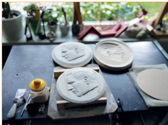
Sádrový odlitek pamětní desky a lukoprenová forma pro odlití do bronzu.
