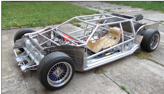
Postupnými úpravami ze Škody 100 George Negru vyrobil nejnižší závodní speciál s uzavřenou karosérií v České republice.
