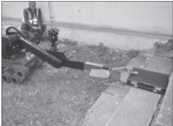
Dálkově ovládaný robot výbušninu převzal a připravil ji k transportu.
