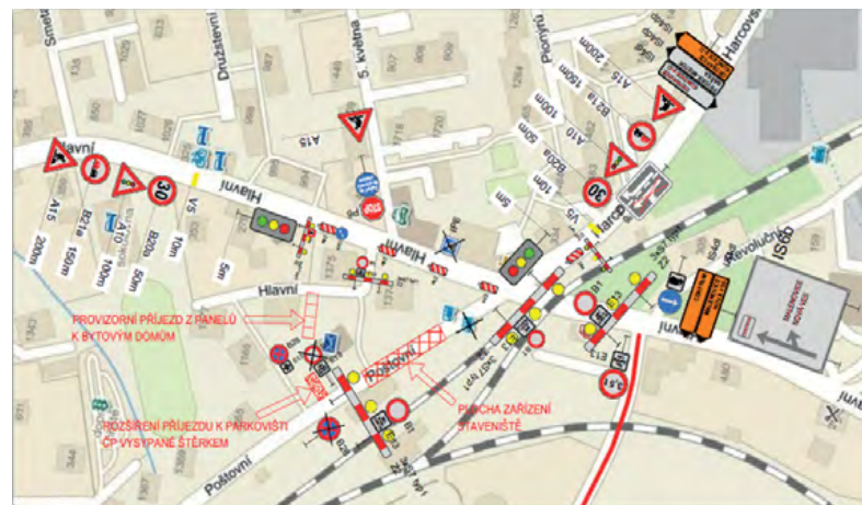
Obr. 2 Uzávěra žel. přejezdu na ul. Hlavní a části ul. Poštovní při realizaci části A stavby v 07, 08/2018.
