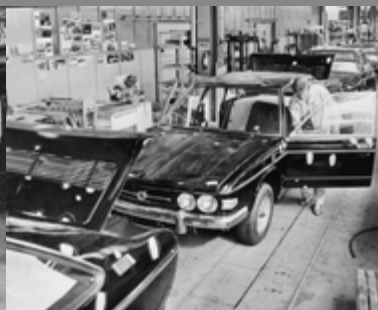
Montáž vozidel – pozemní dopravník – pracoviště kompletace předních dveří
