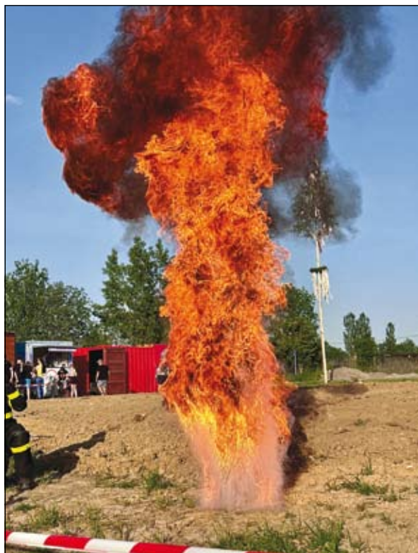
ukázka, co by se stalo, kdybychom rozpálený olej hasili vodou
