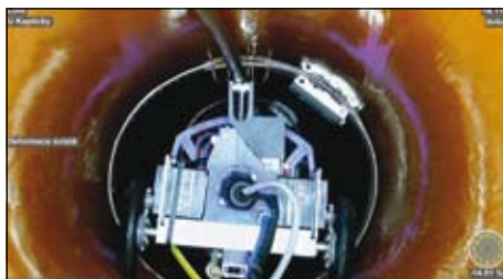
pohled na robota, zacvakávajícího chráničku do spony
