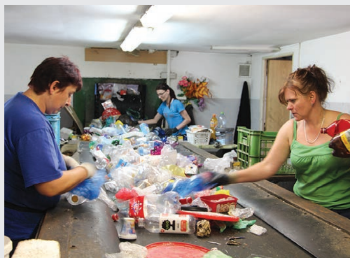
Z kontejnerů míří tříděný odpad na třídící linku ve sběrném dvoře v Karáskově ulici, kde ho pracovníci rozdělí podle druhů a slisují do balíků.
