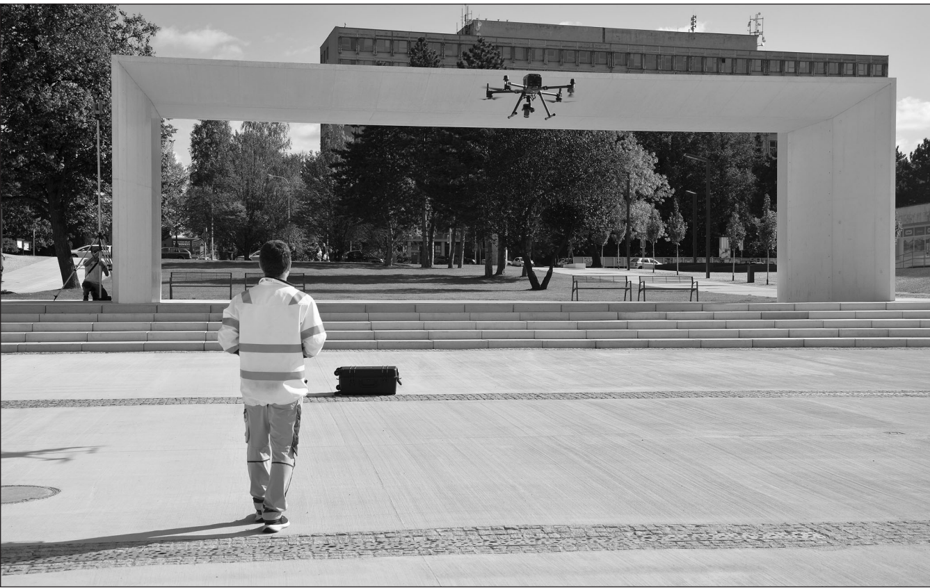
Mimo jiné za pomoci dronu a použití letecké fotogrammetrie byly minulý pátek s vysokou přesností měřeny spády betonových ploch v okolí Lašské brány v centru města. Revitalizace by se ale už měla chýlit ke konci. FOTO: DAVID MACHÁČEK
