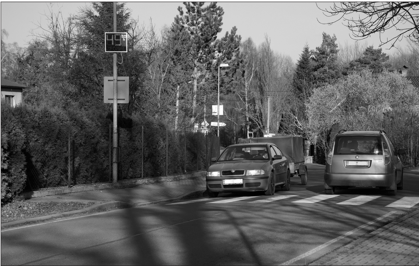
Dva nové informativní radary jsou aktuálně nainstalovány u 'vodárny' a mají nejen upozorňovat řidiče na aktuální rychlost a psychologicky působit na snížení rychlosti, ale i sbírat data o skutečném objemu dopravy v daném místě. FOTO: DAVID MACHÁČEK
