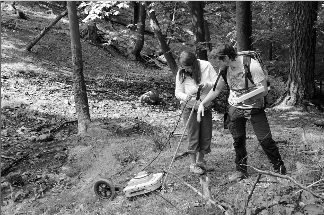
Při prvotním průzkumu prameniště Svěceného potoka napájějícího Větrkovickou přehradu využili odborníci z VŠB-TU i mobilní georadar.
