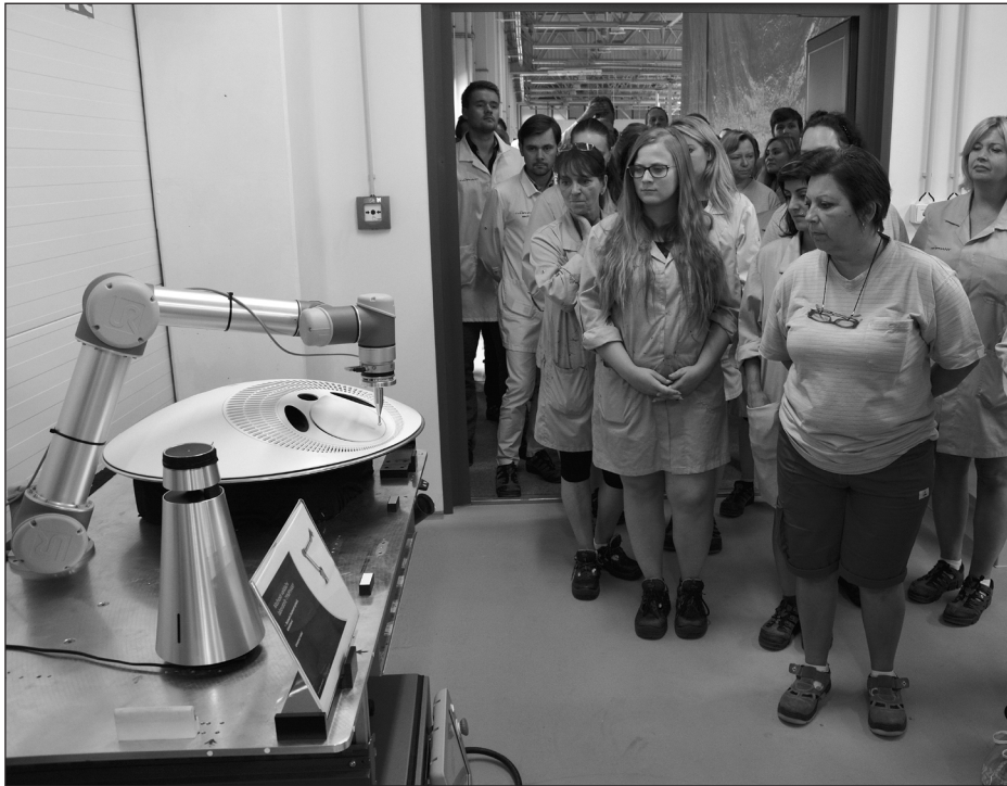
Zaměstnanci společnosti Tymphany si prohlížejí multifunkční robotické rameno, které ve validační laboratoři ověřuje životnost konektorů.
