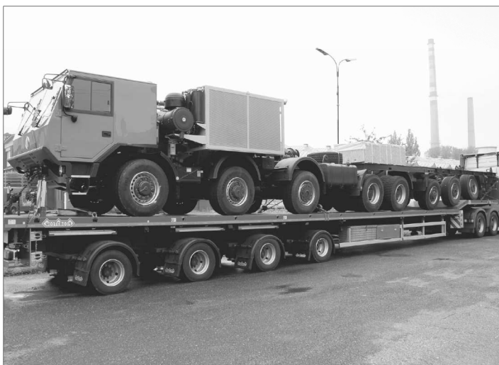
Speciál pro přepravu vrtné plošiny navržený a vyrobený v Tatře je se svými osmnácti metry délky a osmdesáti čtými tunami váhy největší tatrovkou v historii.
