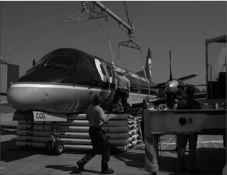
Speciální nafukovací vaky, zvedací rameno a popruhy jsou součástí výbavy, kterou nově disponují záchranáři na mošnovském letišti.
