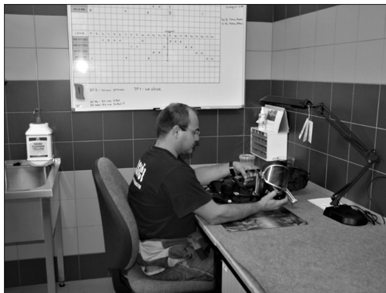
Chemická dílna, kde se provádí údržba dýchací techniky
