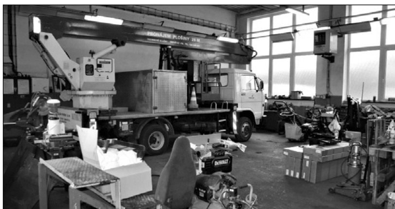
Servis plošiny MAN s dosahem 25m v dílně Technických služeb. Většinový servis techniky si provádí pracovníci TS sami
