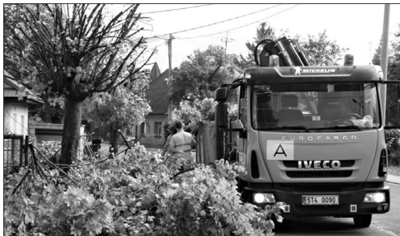
Ořez korun javorů na ulici Dráhy. Vozidlo Iveco s hákovým nosičem a hydraulickou rukou
