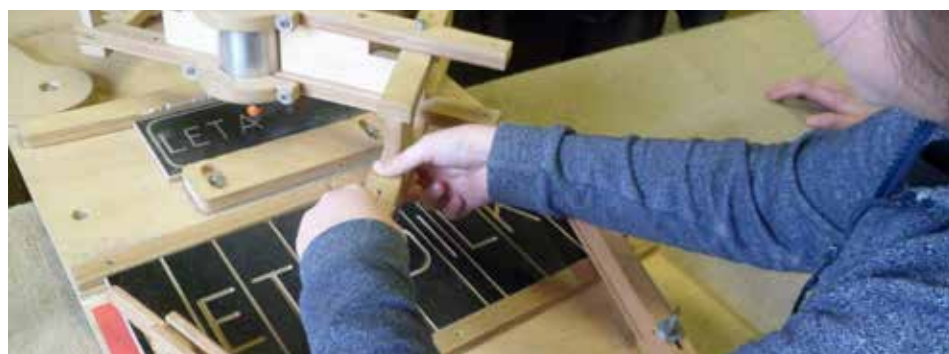
Práce s kopírovací frézou
