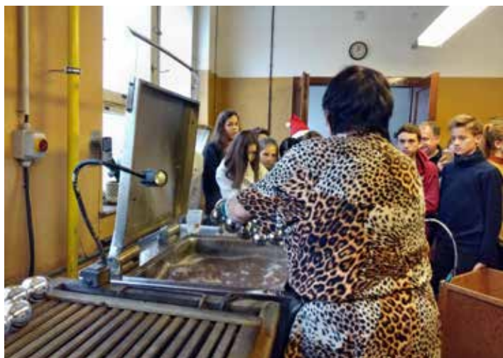
(2) Pak, pevně baňky držíc, je paní ponoří do nádrže s vodou o teplotě 60°C. Proběhne chemická reakce – uvnitř každé baňky se utvoří stříbrný povlak.
