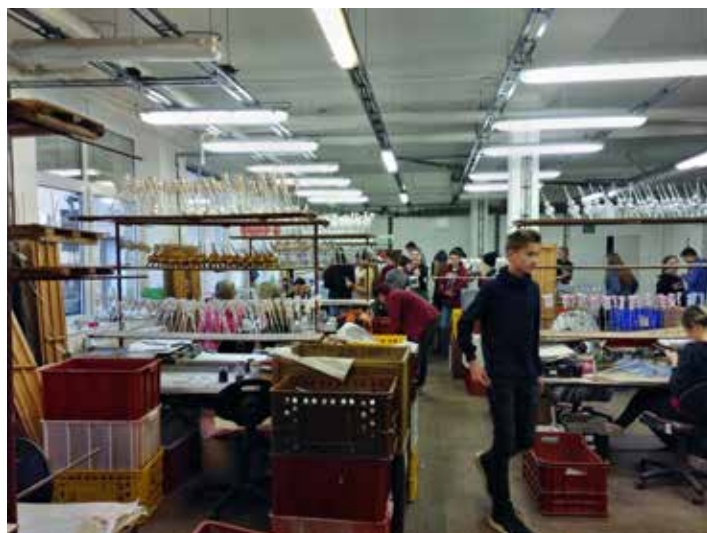
(4) Vystříbřené i číré polotovary, jakož i skleněné tvary foukané do forem – to všechno jde do dílny k malířkám. Ty malují, posypávají, zdobí.
