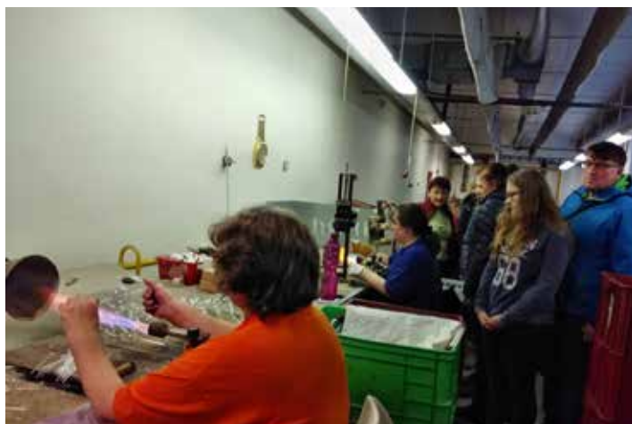
(1) Paní „foukačky“ vyfukují ze skleněných trubic koule. Za osmihodinovou směnu vyfoukne jedna pracovnice 800 větších koulí. Malých baněk pak za směnu vyfoukne až 1500 kusů. Je tady horko, plamen nemilosrdně žhne.
