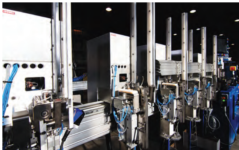
Plně automatická profilovací a stříhací linka pro výrobu venkovních žaluzií
